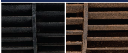
Dual Barrier -pinnoite Ei Dual Barrier -pinnoitetta
